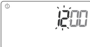
Termostat přejde k nastavení minut. Nastavení opětovně uskutečníme pomocí tlačítek ▼ ▲ a potvrďme stiskem tlačítka **OK**.
